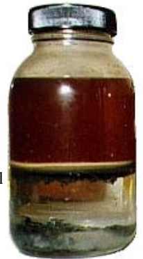
Öl / Wasser Muster mit Zwischenschicht
