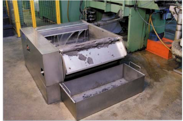
Bandfilter mit Seiteneinlauf, Tank und Sammelbehälter.
