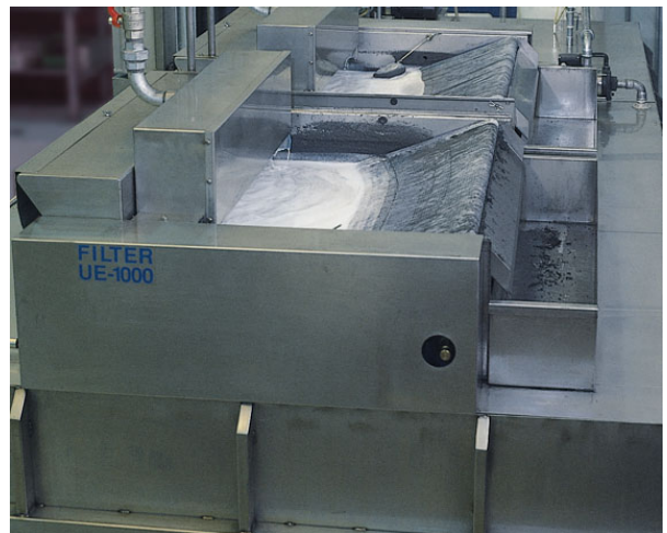
Bandfilter mit Top-Einlauf in rechts- und linksgerichteter Ausführung, Tank und Sammelbehälter.
